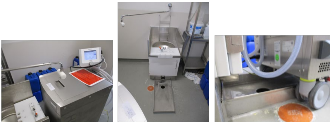
Abbildung 2: Beispiel für eine Befüll- und Entleerstation von Hypothermiegeräten
