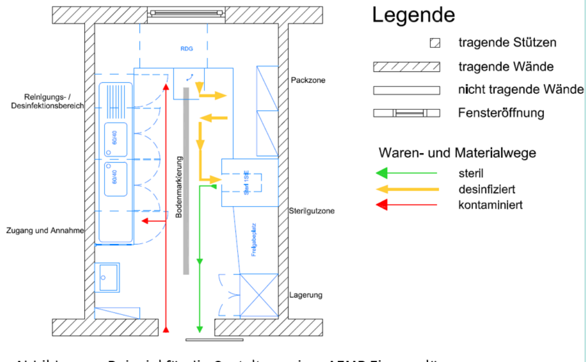
Abbildung 10 Beispiel für die Gestaltung einer AEMP Einraumlösung
